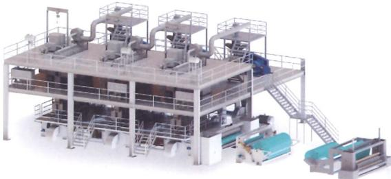
高端单 M 熔喷非织造布生产线 + 后处理水刺驻极生产线（垂直喷式 / 水平喷式）
