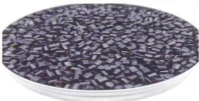
我们先来了解一下驻极母粒的基本特性。驻极母粒是一种采用熔融混合工艺制得的粘稠物质，通常由聚丙烯等聚合物材料制成。它具有优异的熔点、耐磨性和加工性能，能够在高温下快速熔化并形成纤维状物质。由于其高强度、低毛羽、尺寸稳定性等特点，驻极母粒被广泛应用于纺织领域。
