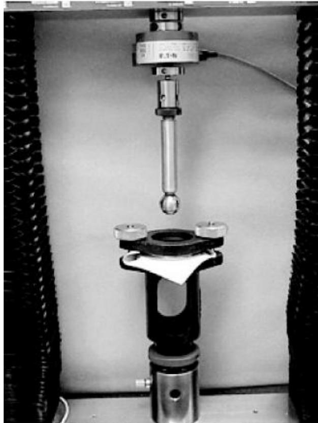
圖 1 頂破強力試驗裝置
