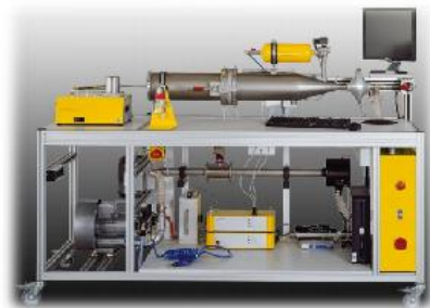
TOPAS AFC-131 过滤材料反吹性能实验台
