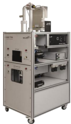
PALAS MFP3000 单张滤料过滤性能测试台
