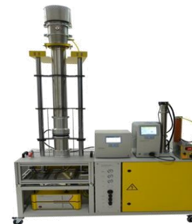
TOPAS MBP116 超高效空气滤材过滤性能试验台
