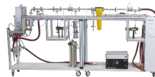
PALAS DFP3000 压缩空气过滤器及滤材过滤测试台
