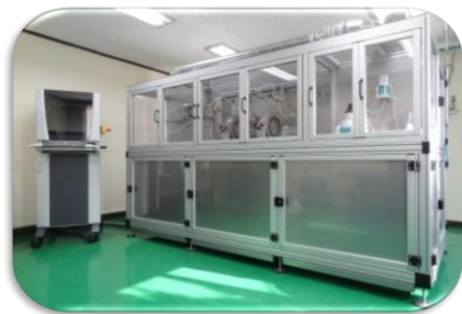
GMN FWSETB-900-10 在线燃油水分离效率试验台
